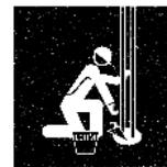
Entfernung von Umkleidungen und Isolierungen aus dem Gefährdungsbereich (bei Arbeiten an Rohrleitungen, Kesseln und Behältern).
