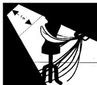
**1.6** Werden Elektro-Wärmeegeräte unsachgemäß installiert oder aufgestellt, so können sie eine Brandgefahr darstellen.
