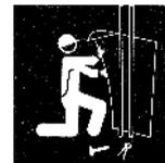
Abdichtung der Öffnungen, Fugen, Ritzen, Rohrdurchführungen und offenen Rohrleitungen, die vom Gefährdungsbereich in andere Räume führen, mit nichtbrennbaren Stoffen; geeignet sind z.B. Gips, Mörtel, feuchte Erde oder Lehm. Auf keinen Fall dürfen Lappen, Papier oder andere brennbare Stoffe verwendet werden.
